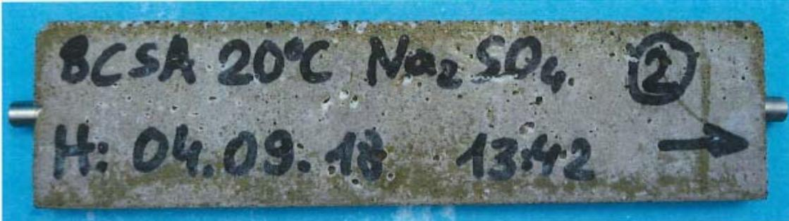
**Bild A3.1:** Probekörper mit dem belitischen CSA-Zement "Rapid Set" nach 180 Tagen Lagerung in  $\text{Na}_2\text{SO}_4$ -Lösung bei 20 °C
