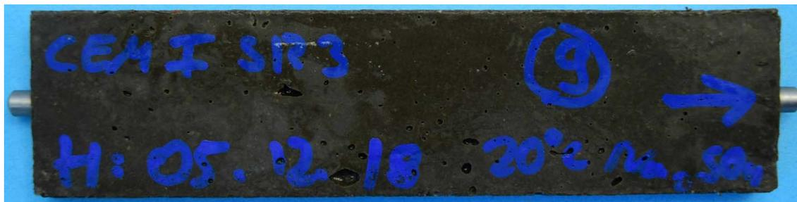
**Bild A3.9:** Probenkörper mit CEM I 42,5 R-SR3 nach 180 Tagen Lagerung in  $\text{Na}_2\text{SO}_4$ -Lösung bei  $20^\circ\text{C}$
