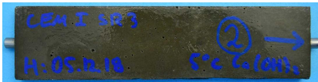
**Bild A3.12:** Probenkörper mit CEM I 42,5 R-SR3 nach 90 Tagen Lagerung in  $\text{Ca}(\text{OH})_2$ -Lösung bei  $5^\circ\text{C}$
