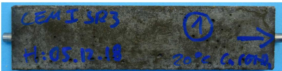
**Bild A3.10:** Probenkörper mit CEM I 42,5 R-SR3 nach 180 Tagen Lagerung in  $\text{Ca}(\text{OH})_2$ -Lösung bei  $20^\circ\text{C}$
