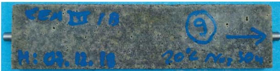
**Bild A3.5:** Probenkörper mit CEM III/B 42,5 N-SR nach 180 Tagen Lagerung in  $\text{Na}_2\text{SO}_4$ -Lösung bei 20 °C
