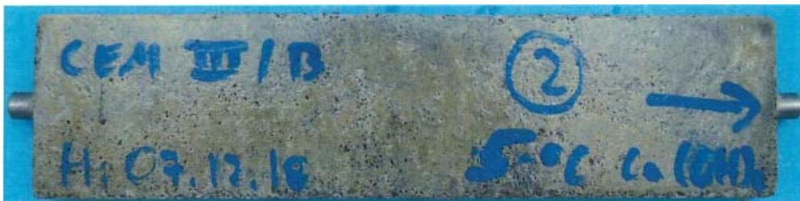
**Bild A3.8:** Probenkörper mit CEM III/B 42,5 N-SR nach 90 Tagen Lagerung in  $\text{Ca}(\text{OH})_2$ -Lösung bei 5 °C
