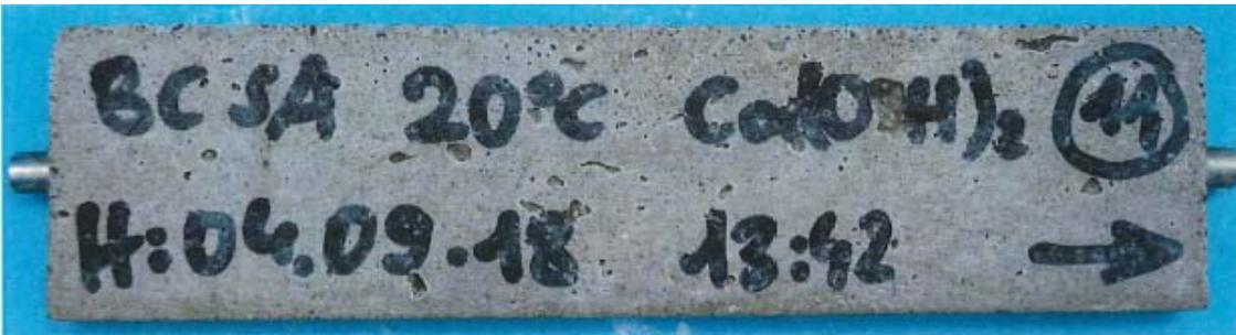
**Bild A3.2:** Probekörper mit dem belitischen CSA-Zement "Rapid Set" nach 180 Tagen Lagerung in  $\text{Ca(OH)}_2$ -Lösung bei 20 °C
