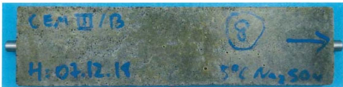
**Bild A3.7:** Probenkörper mit CEM III/B 42,5 N-SR nach 90 Tagen Lagerung in  $\text{Na}_2\text{SO}_4$ -Lösung bei 5 °C
