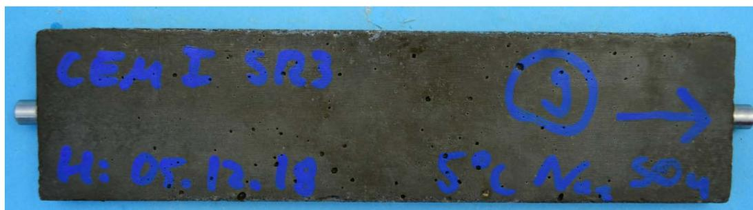
**Bild A3.11:** Probenkörper mit CEM I 42,5 R-SR3 nach 90 Tagen Lagerung in  $\text{Na}_2\text{SO}_4$ -Lösung bei  $5^\circ\text{C}$
