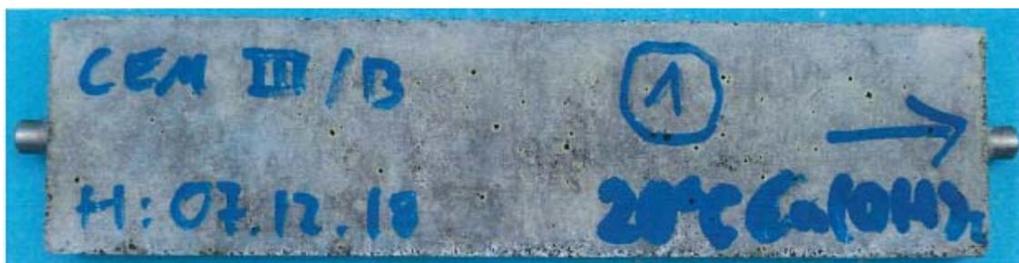
**Bild A3.6:** Probenkörper mit CEM III/B 42,5 N-SR nach 180 Tagen Lagerung in  $\text{Ca}(\text{OH})_2$ -Lösung bei 20 °C
