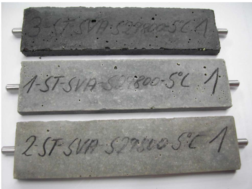
**Bild A2:** Probekörper nach 90 Tagen Lagerung in  $\text{Na}_2\text{O}_4$ -Lösung bei 5 °C
