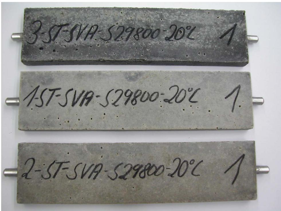
**Bild A1:** Probekörper nach 180 Tagen Lagerung in  $\text{Na}_2\text{O}_4$ -Lösung bei 20 °C
