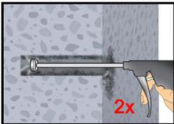
2a. Das Bohrloch vom Bohrlochgrund her 2x vollständig mit Druckluft (min. 6 bar) (Anhang B 5) ausblasen, bis die ausströmende Luft staubfrei ist. Bei tiefen Bohrlöchern sind geeignete Verlängerungen zu verwenden.
