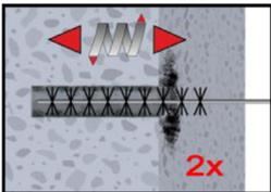
2b. Bohrloch mit geeigneter Drahtbürste gem. Tabelle B5 (minimaler Bürstendurchmesser  $d_{b,min}$  ist einzuhalten und zu überprüfen) 2x mittels eines Akkuschaubers oder einer Bohrmaschine ausbürsten.
