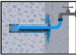
2a. Mit Wasser ausspülen, bis klares Wasser aus dem Bohrloch austritt.
