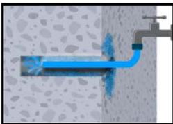
2c. Erneut mit Wasser ausspülen, bis klares Wasser aus dem Bohrloch austritt.
