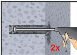
2c. Anschließend das Bohrloch erneut vom Bohrlochgrund her 2x vollständig mit Druckluft (min. 6 bar) (Anhang B 5) ausblasen, bis die ausströmende Luft staubfrei ist. Bei tiefen Bohrlöchern sind geeignete Verlängerungen zu verwenden.
