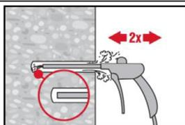
Bohrloch erneut vom Bohrlochgrund über die gesamte Länge 2-mal mit Druckluft ausblasen, bis die rückströmende Luft staubfrei ist.
