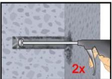
**2d.** Das Bohrloch vom Bohrlochgrund her 2x vollständig mit Druckluft (min. 6 bar) (Anhang B 3) ausblasen, bis die ausströmende Luft staubfrei ist. Bei tiefen Bohrlöchern sind Verlängerungen zu verwenden.
