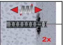
**2b.** Bürstendurchmesser prüfen (Tabelle B4). Das Bohrloch ist mit geeigneter Drahtbürste >  $d_{b,min}$  (Tabelle B4) minimum 2x mit Drehbewegungen auszubürsten. Wird der Bohrlochgrund mit der Bürste nicht erreicht, muss eine Bürstenverlängerung verwendet werden.
