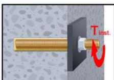
11. Nach vollständiger Aushärtung kann das Anbauteil mit bis zu dem maximalen Drehmoment (Tabelle B1 oder B3) montiert werden. Die Mutter muss mit einem kalibriertem Drehmomentschlüssel festgezogen werden. Bei der Vorsteckmontage kann optional der Ringspalt zwischen Ankerstange und Anbauteil nachträglich mit Mörtel verfüllt werden. Dafür Unterlegscheibe durch Verfüllscheibe ersetzen und Mischerreducierung auf den Mischer stecken. Der Ringspalt ist verfüllt, wenn Mörtel austritt.
