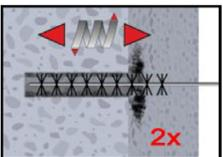
**2e.** Bürstendurchmesser prüfen (Tabelle B4). Das Bohrloch ist mit geeigneter Drahtbürste >  $d_{b,min}$  (Tabelle B4) minimum 2x mit Drehbewegungen auszubürsten. Wird der Bohrlochgrund mit der Bürste nicht erreicht, muss eine Bürstenverlängerung verwendet werden.
