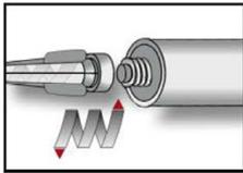
3. Den mitgelieferten Statikmischer fest auf die Kartusche aufschrauben und Kartusche in eine geeignete Auspresspistole einlegen. Bei jeder Arbeitsunterbrechung länger als die maximale Verarbeitungszeit (Tabelle B5) und bei jeder neuen Kartusche ist der Statikmischer zu erneuern.
