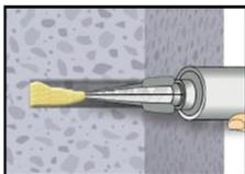
6. Gereinigtes Bohrloch vom Bohrlochgrund her ca. zu 2/3 mit Verbundmörtel befüllen. Langsames Zurückziehen des Statikmischers aus dem Bohrloch verhindert die Bildung von Lufteinschlüssen. Wird der Bohrlochgrund nicht erreicht, muss eine passende Mischerverlängerung verwendet werden. Die temperaturrelevanten Verarbeitungszeiten (Tabelle B5) sind zu beachten.
