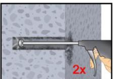
**2f.** Abschließend das Bohrloch erneut vom Bohrlochgrund her 2x vollständig mit Druckluft (min. 6 bar) (Anhang B 3) ausblasen, bis die ausströmende Luft staubfrei ist. Bei tiefen Bohrlöchern sind Verlängerungen zu verwenden.
