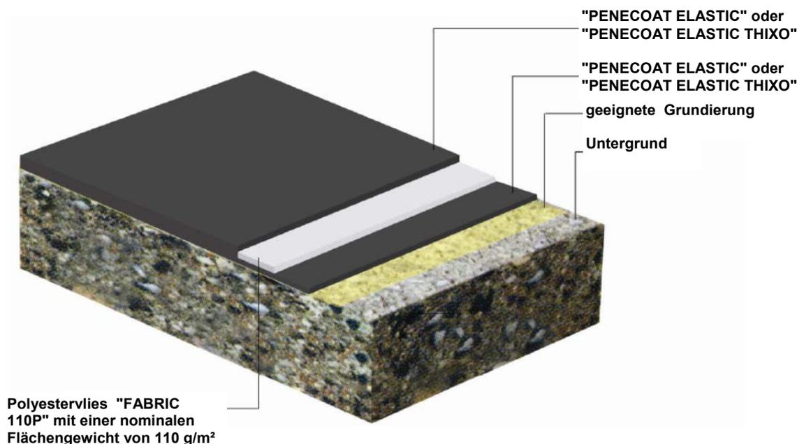
für die Dachabdichtungen "PENECOAT ELASTIC,
