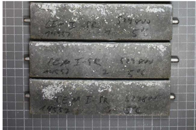
**Bild 3:** Probekörper mit CEM I 42,5 N-SR3 nach der Sulfatlagerung;
