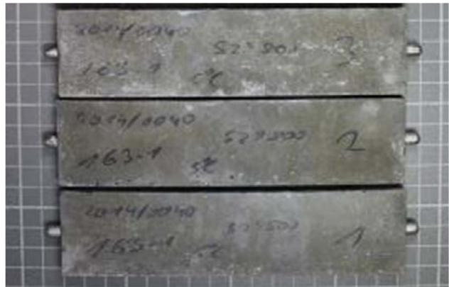
**Bild 2:** Probekörper mit CEM III/B 42,5 N-LH/SR/LA nach der Sulfatlagerung;
