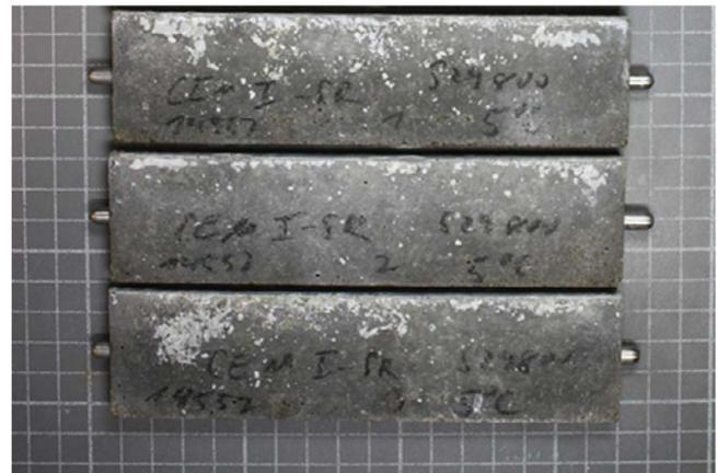
**Bild 3:** Probekörper mit CEM I 42,5 N-SR3 nach Sulfatlagerung;
