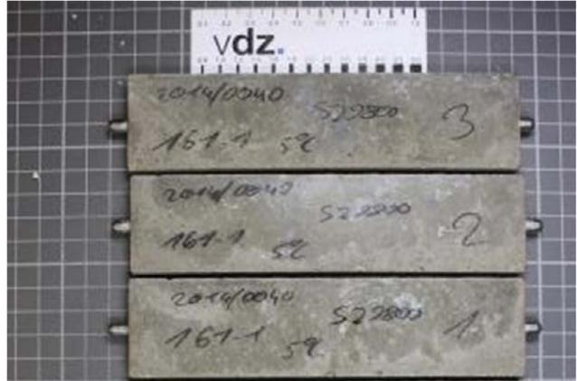
**Bild 1:** Probekörper mit CEM III/A 42,5 N-LH/SR/LA "Bernburg" nach Sulfatlagerung;
