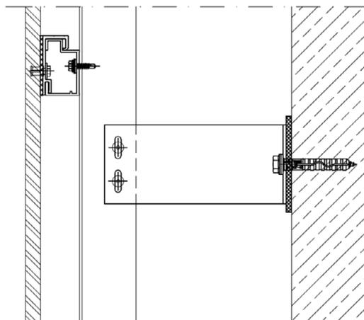
Infinity KEIL Hinterschnittanker KH
