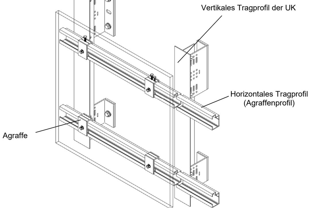
Infinity KEIL Hinterschnittanker KH
