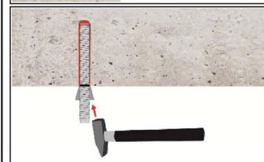
8a. Bei Überkopfmontage ist der Bewehrungsstab bis zum Start der Aushärtung zu fixieren (z.B. Holzkeile).
