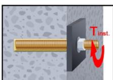
11. Nach vollständiger Aushärtung kann das Anbauteil mit bis zu dem maximalen Drehmoment (Tabelle B1 oder B3) montiert werden. Die Mutter muss mit einem kalibriertem Drehmomentschlüssel festgezogen werden. Bei der Vorsteckmontage kann optional der Ringspalt zwischen Ankerstange und Anbauteil nachträglich mit Mörtel verfüllt werden. Dafür Unterlegscheibe durch Verfüllscheibe ersetzen und Mischerrreduzierung auf den Mischer stecken. Der Ringspalt ist verfüllt, wenn Mörtel austritt.
