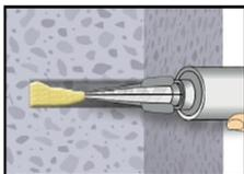
6. Gereinigtes Bohrloch vom Bohrlochgrund her ca. zu 2/3 mit Verbundmörtel befüllen. Langsames Zurückziehen des Statkmischers aus dem Bohrloch verhindert die Bildung von Lufteinschlüssen. Wird der Bohrlochgrund nicht erreicht, muss eine passende Mischerverlängerung verwendet werden. Die temperaturrelevanten Verarbeitungszeiten (Tabelle B5) sind zu beachten.
