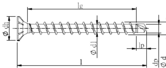
Vollgewinde mit Bohrspitze
