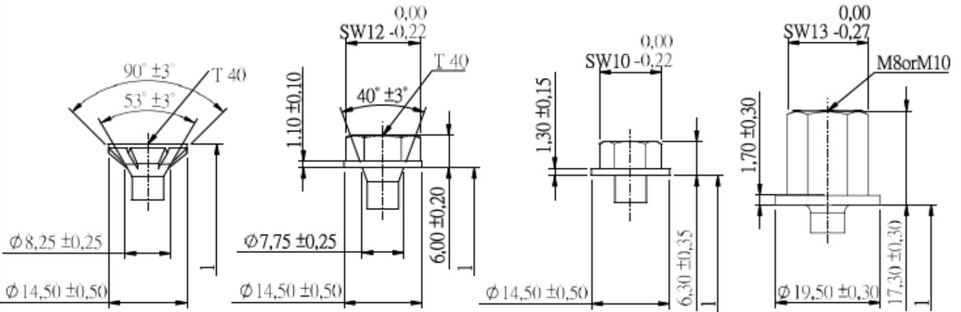
Senkkopf mit Fräsrippen - Ausführung mit und ohne Linse
