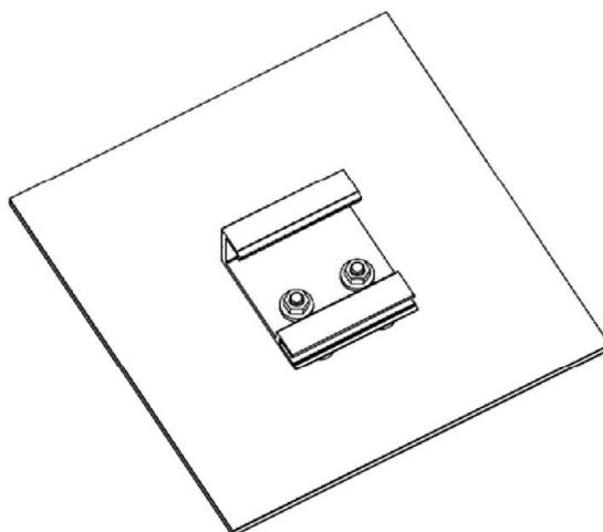
3. Neben der optischen Kontrolle ist der korrekte Einbau der Agraffen durch Einführen der Messlehre zu kontrollieren.
