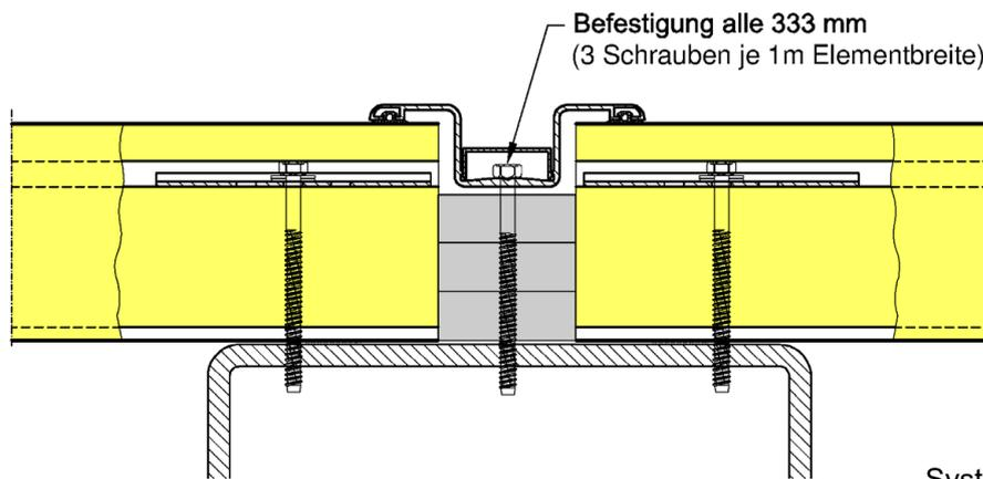
2. Beispiel für die Anwendung mit "isowand integral" (Querfuge)
