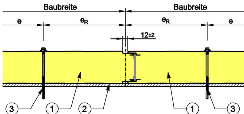
**Direkte Befestigung des Wandelementes "Thermowand TL"**
