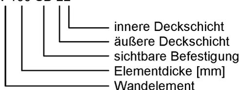
Sandwichelemente "SIM" nach DIN EN 14509 mit Mineralwolle-Kernschicht für Außenwandkonstruktionen
