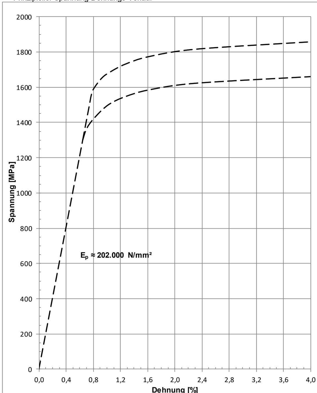
Die Linien geben eine Orientierung für den prinzipiellen Spannungs-Dehnungs-Verlauf bei Annahme des Rechenwerts des E-Moduls ( $E_p$ ) von 202.000 N/mm<sup>2</sup>.
