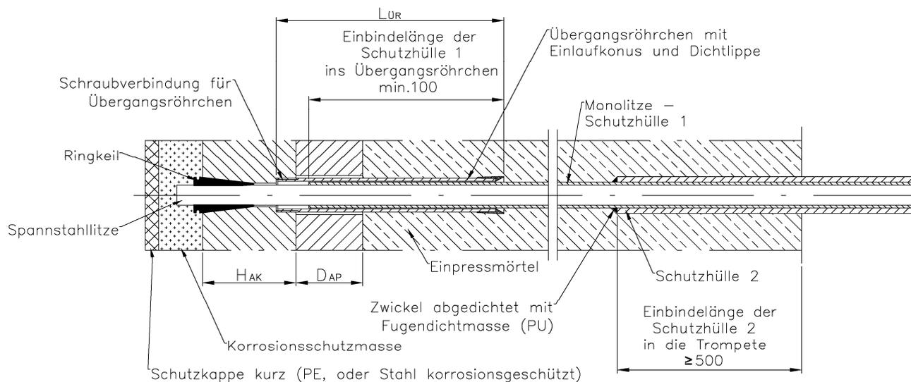
Ausbildung des Korrosionsschutzes bei langen
