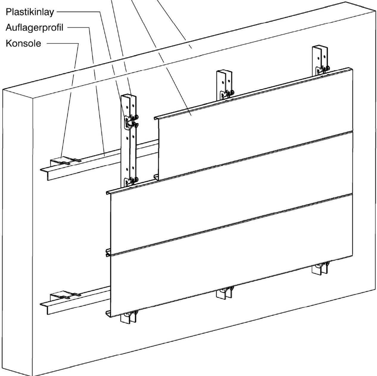
Fassadensystem Kalzip FC aus Aluminium und seine Produkte
