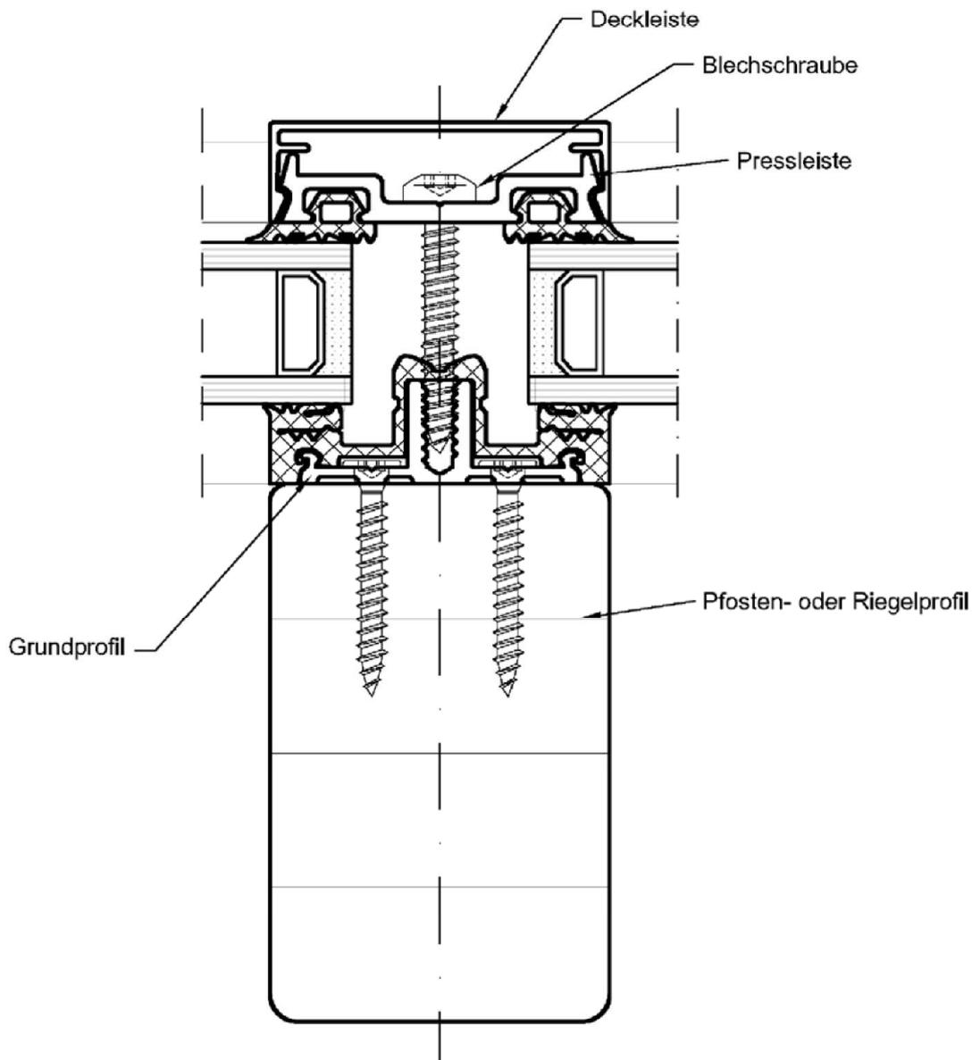
Befestigungssystem und seine Komponenten für das Fassadensystem
