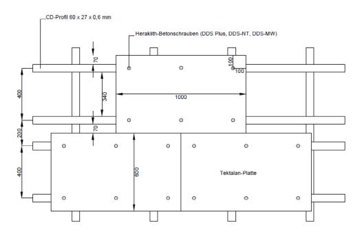
Befestigung von Dämmplatten an CD-Profilen mit Heraklith Betonschrauben DDS plus, DDS-MW und DDS-NT
