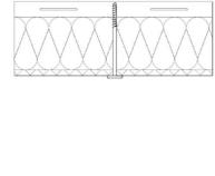
Befestigung von Dämmplatten an CD-Profilen mit Heraklith Betonschrauben DDS plus, DDS-MW und DDS-NT
