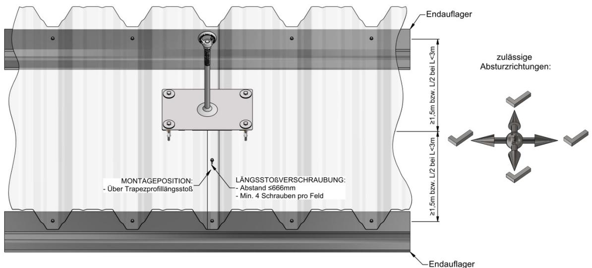
**Abbildung 1a - Montagevorgaben auf Trapezprofil (Positivlage) bei Absturzrichtung quer zur Trapezprofilspanrichtung**
