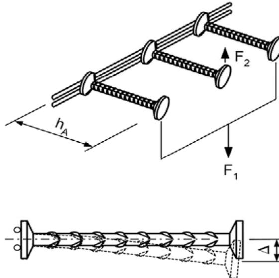
Der Bruch der Dehnung darf nicht vor Erreichen der Auslenkung um  $\Delta = 1/10 h_A$  erfolgen. Die Bruchlast darf 0,5 kN nicht unterschreiten.
