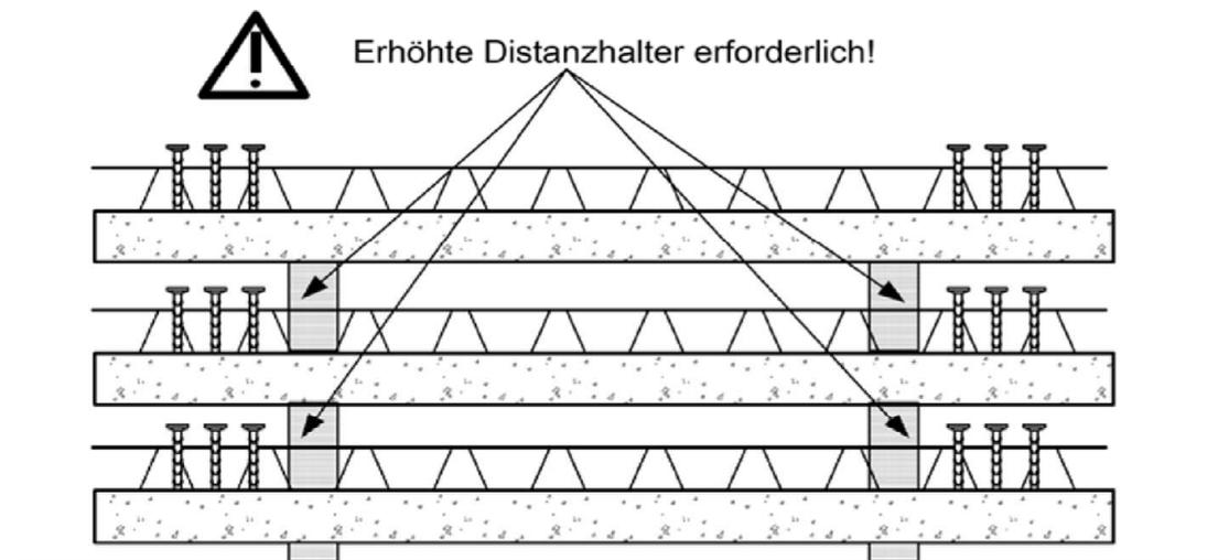
Beim Lagern und Transportieren von Elementdecken sind die ancoPLUS® - Schubbewehrung zu beachten, die aufgrund ihrer Höhe über die Gitterträger hinausragen. Die zur Auflagerung der Elementdecken erforderlichen Distanzhalter sind entsprechend zu erhöhen.
