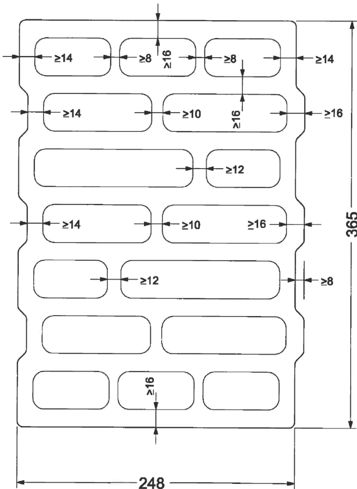
Mauerwerk aus POROTON Planhochlochziegeln mit integrierter Wärmedämmung
