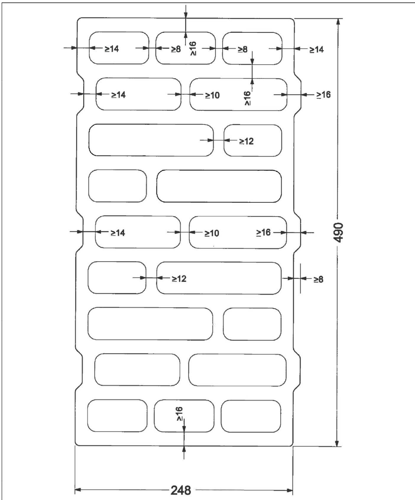
Mauerwerk aus POROTON Planhochlochziegeln mit integrierter Wärmedämmung
