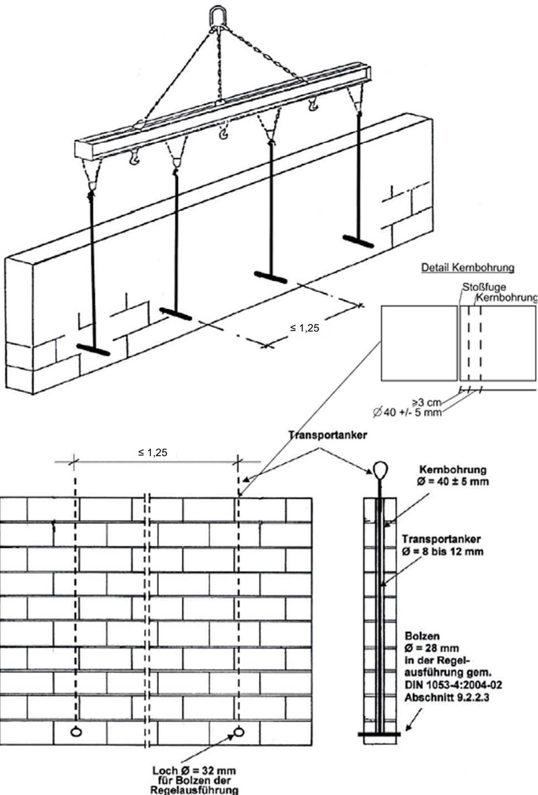
Vorgefertigte Mauertafeln aus Mauerwerk im Klebeverfahren
