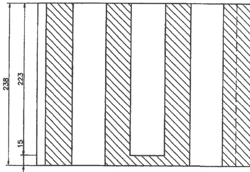
Die Stirnflächen der isobims-Hohlblöcke mit Nut und Feder dürfen alternativ mit Nut und Feder mit Mörteltasche nach Anlage 11 oder mit Nut und Feder ohne Mörteltasche nach Anlagen 12, 13, 14 oder 15 ausgebildet sein.
