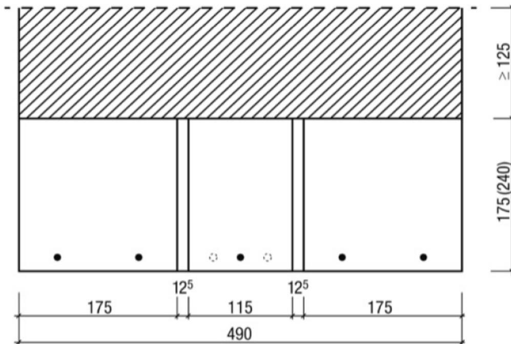
Flachstürze mit Zuggurten aus bewehrtem Beton oder Leichtbeton
