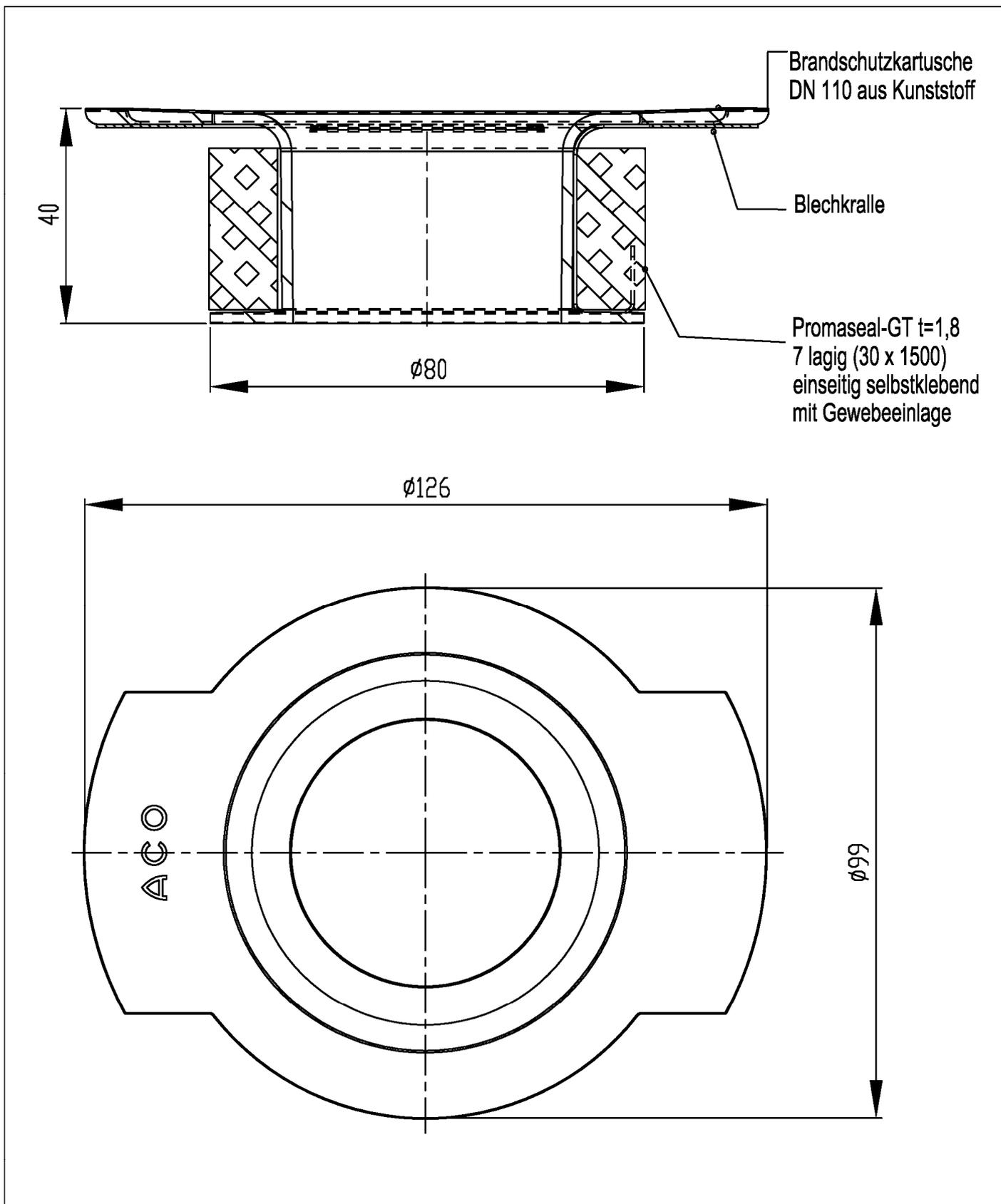
Zubehörteile für feuerwiderstandsfähige Abschottung "System Bodenabläufe Easy Flow"
