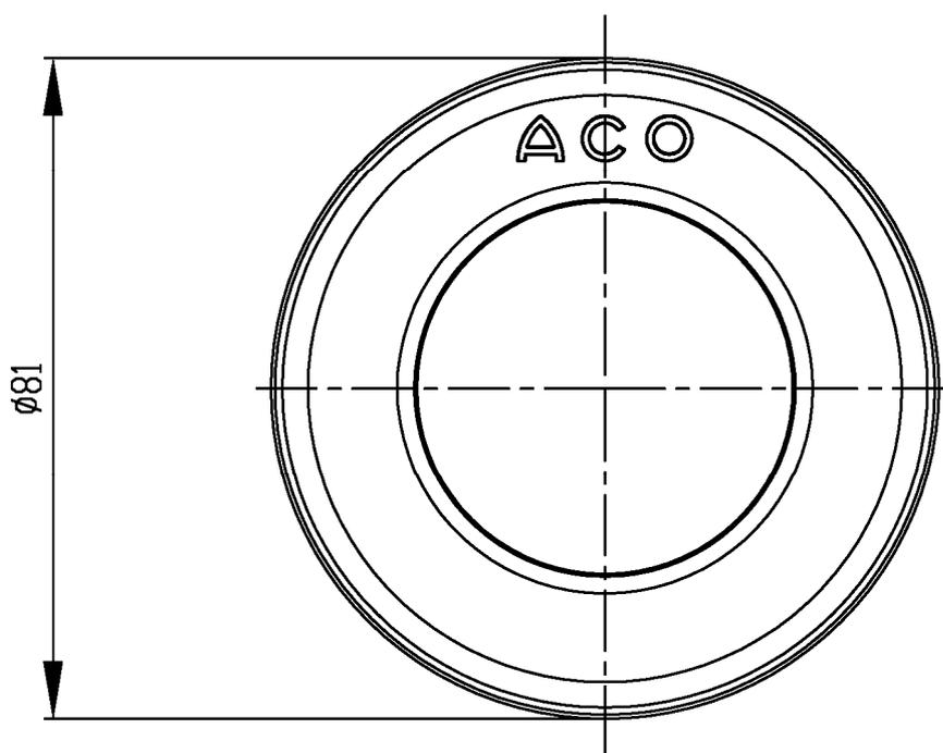
Zubehörteile für feuerwiderstandsfähige Abschottung "System Bodenabläufe Easy Flow"
