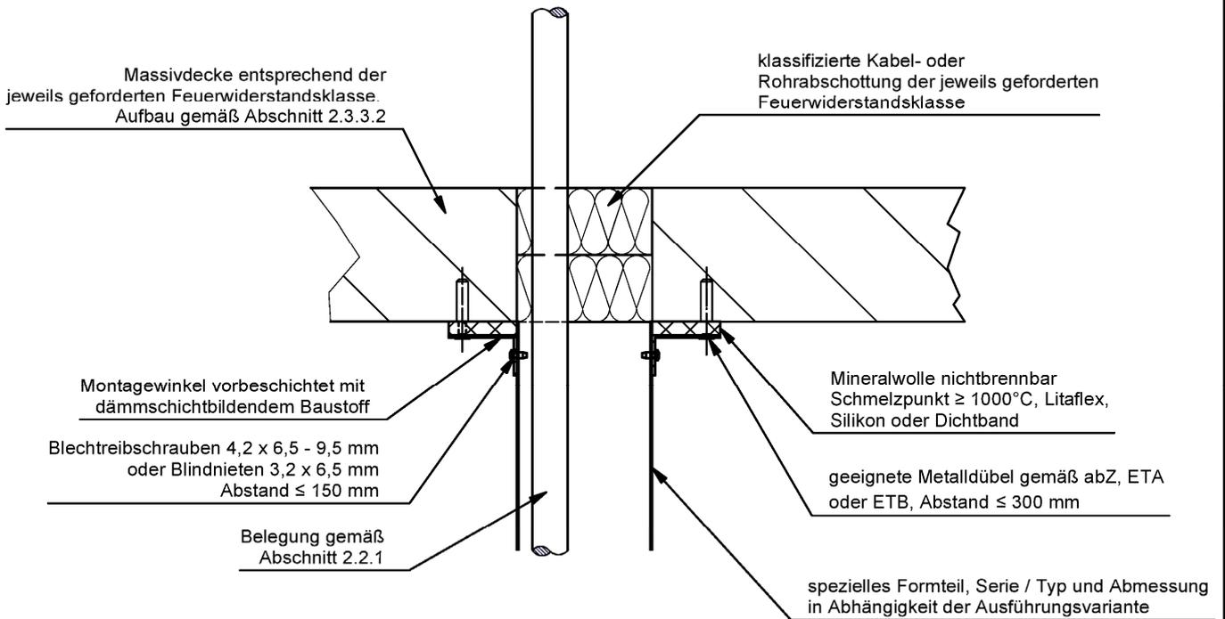
Befestigungsabstände des Installationskanals gemäß Abschnitt 3.2.2, Tabelle 5
