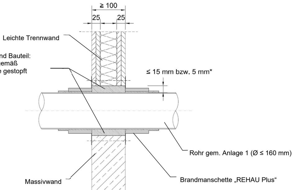
\* wahlweise darf ein 5 mm dicker PE-Weichschaumstreifen gem. Abschnitt 2.1.2 eingepipst bzw. eingemörtelt werden
