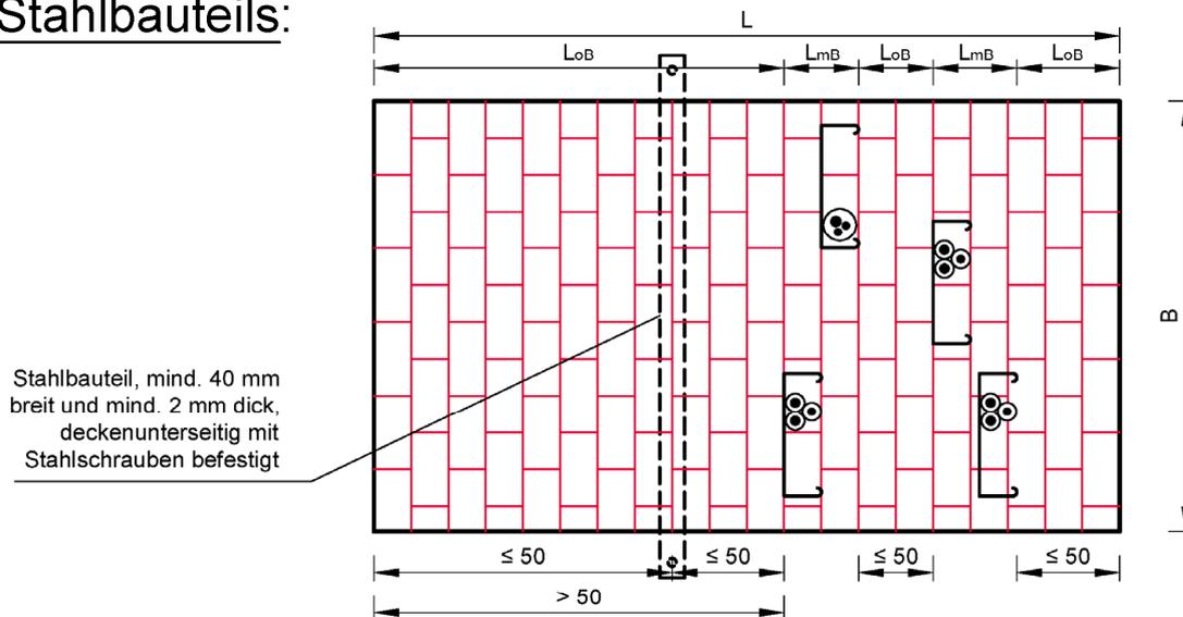
Bei der Errichtung von Abschottungen in Öffnungen in feuerbeständigen Massivdecken (s. Anlagen 5 - 7) mit einer Breite  $B > 50$  cm und  $B \leq 70$  cm muss in Abschottungen ohne Belegung bzw. in Bereichen ohne Belegung mit einer Länge  $L_{oB} > 50$  cm eine der folgenden Maßnahmen erfolgen:
