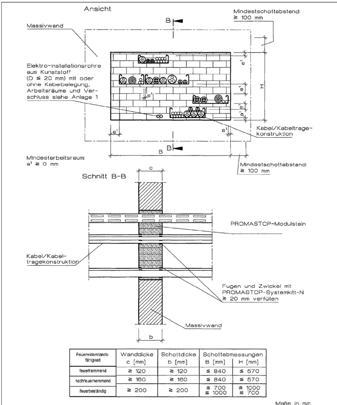
Feuerwiderstandsfähige Abschottung für elektrische Leitungen "PROMASTOP-Kabelschott, Modulstein"
