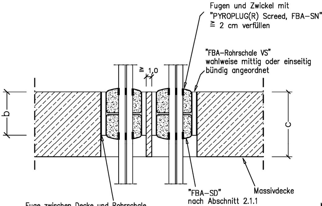
Fugen und Zwickel mit "PYROPLUG(R) Screed, FBA-SN"  $\cong 2$  cm verfüllen
