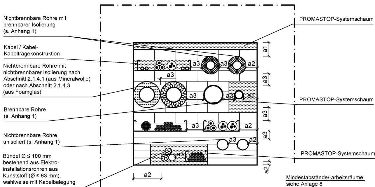
Teilbereiche zwischen Installationen sowie zwischen Installationen und den Öffnungslaibungen können bis zu einer Größe von maximal 450 mm x 500 mm (Breite x Höhe) oder 0,225 m<sup>2</sup> mit „PROMASTOP-Systemschaum“ gemäß Abschnitt 2.1.2.2 ausgefüllt werden. Spalten zwischen „PROMASTOP-Modulsteinen“ und Öffnungslaibung können bis zu einer Breite von 60mm verschlossen werden. Die Verfüll-Tiefe mit „PROMASTOP-Systemschaum“ muss jeweils der Mindestschottdicke von 200 mm entsprechen.
