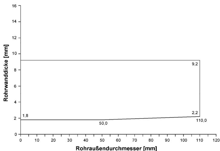
Rohre der Rohrgruppe B nach Anhang 1: PE-HD, PE-LD,
