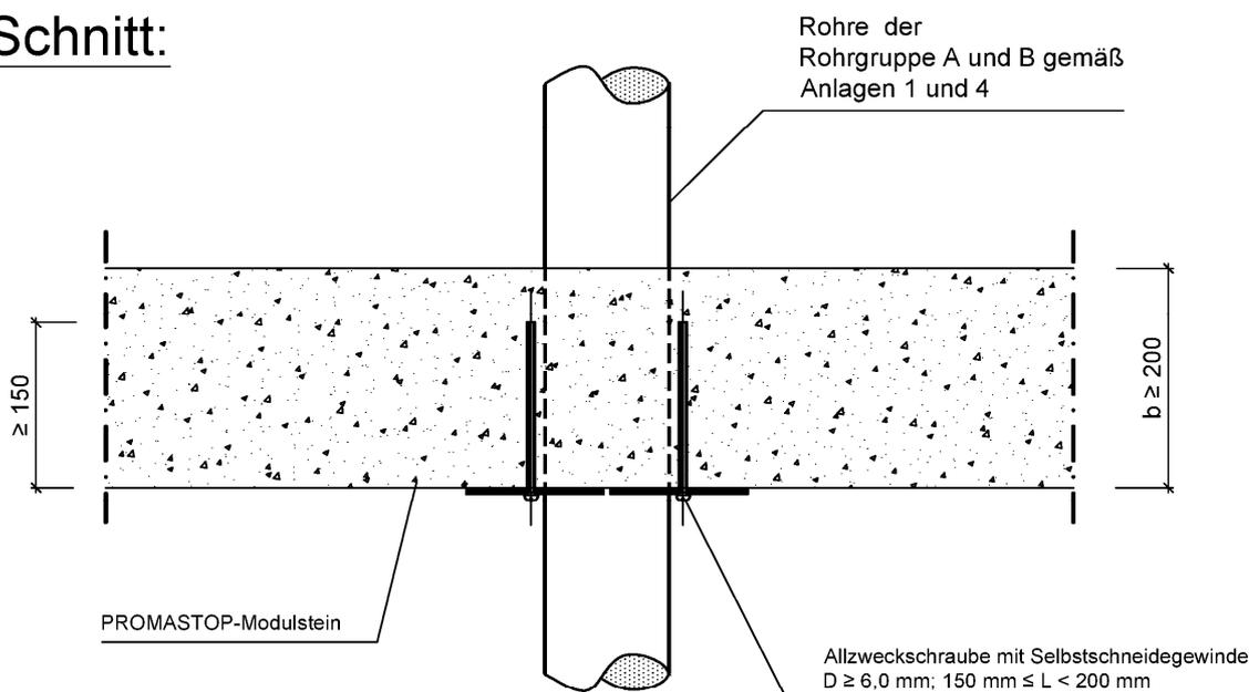
Feuerwiderstandsfähige Abschottung für elektrische Leitungen und/oder Rohrleitungen aus Kunststoff oder Metall "PROMASTOP-Kombischott, Modulstein"
