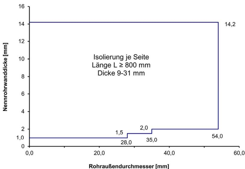
Die Rohrisolierung/Streckenisolierung darf wahlweise durch die Abschottung hindurchgeführt werden oder beidseitig an die Schottoberflächen angrenzen. Die Isolierungen sind gemäß Herstellerangaben an den Stoß- und Längsfugen zu verkleben (u.a. mit selbstklebenden Streifen aus flexiblem Elastomerschaum mit einer Breite  $\geq 50$  mm und einer Dicke von ca. 3 mm).
