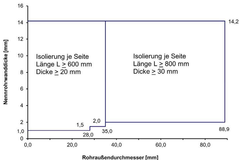
Bei Einbau in nichttragende, raumabschließende Wandkonstruktionen nach Abschnitt 2.2.1, Tab. 3 sind nur Rohre bis zu einem Außendurchmesser von 35mm zulässig (s. Anlage 2)
