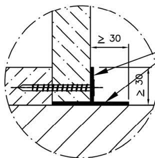
"Brandschutzdichtmasse CP 619" appliziert im Eckbereich Platte zur Bauteillaubung und als Überlappung im Stossbereich Platte zur Bauteillaubung.
