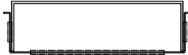
COMAX P Kastenbreite 60-80-110-140-160-190-220-240 Hohe Abdeckung Kastenhöhe 36mm
