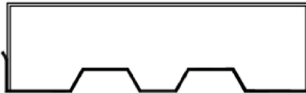
COMAX P Kastenbreite 220 Abdeckung Zellulose / PVC; Endkappe Styropor / PP Kastenhöhe 30mm
