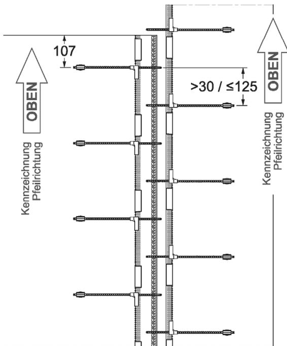
**Bild 9: Einbauvariante B**
