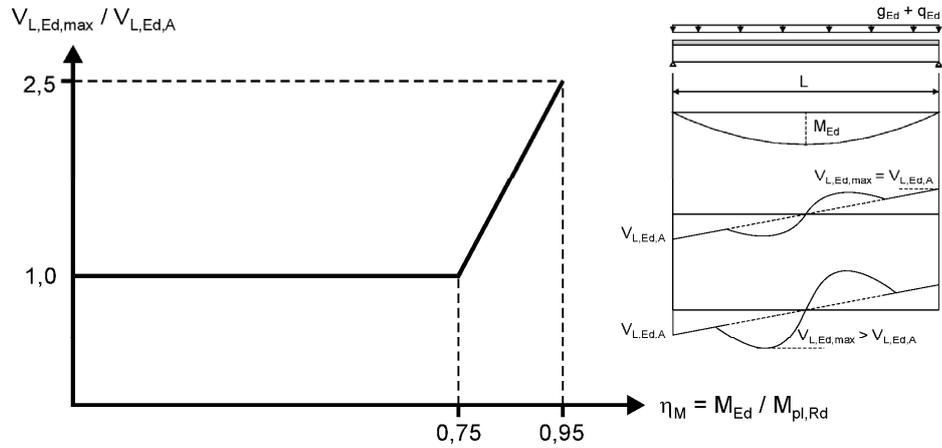
Bemessungsdiagramm zur Ermittlung der maximalen Längsschubkraft bei nichtlinearer Bemessung des Stahlverbundträgers der Hoesch Additiv Decke<sup>®</sup> ohne Eigengewichtsverbund
