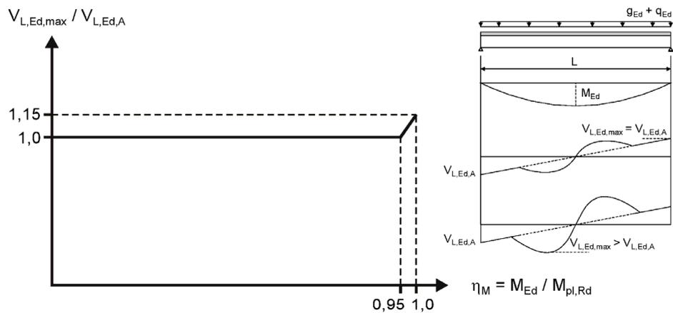
Bemessungsdiagramm zur Ermittlung der maximalen Längsschubkraft bei nichtlinearer Bemessung des Stahlverbundträgers der Hoesch Additiv Decke<sup>®</sup> mit Eigengewichtsverbund
