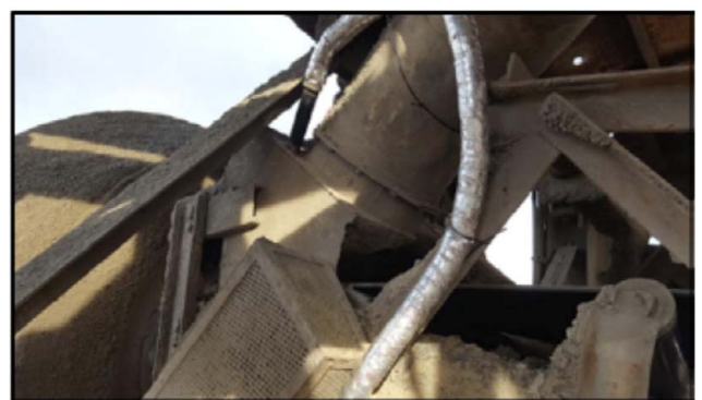
Abb. 3: Positionierung der Einspritzdüse an einem zentralen Mischer
