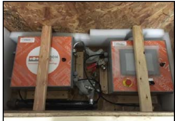
Abb. 5: Lieferzustand von Dosiereinheit (links) und Kontrolleinheit (rechts) in Lieferkiste (ohne Verbindungsschläuche und Isolationsmaterial)
