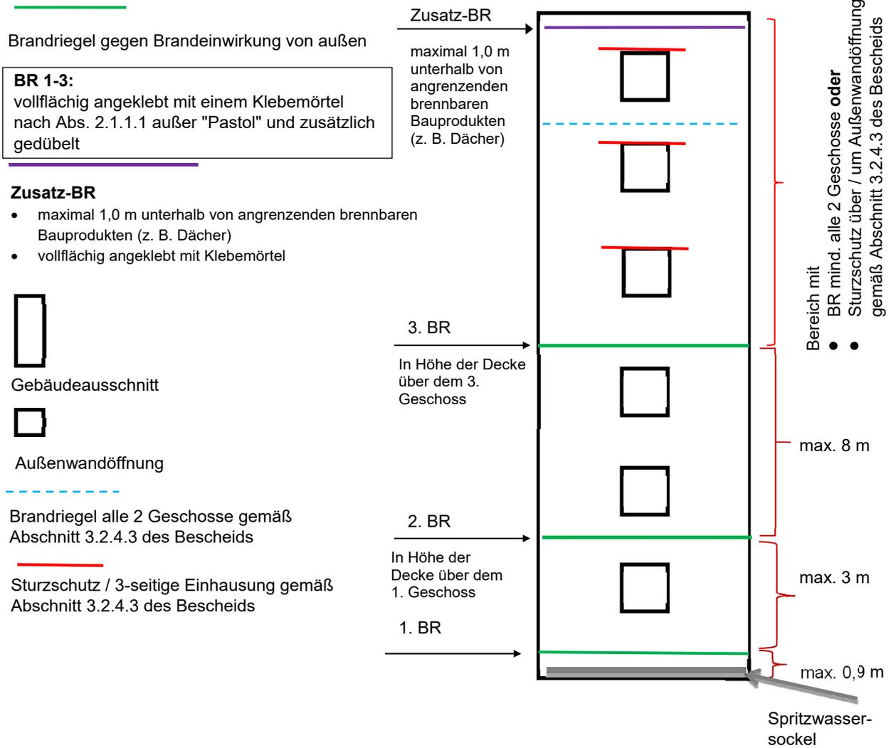
Anordnung der konstruktiven Brandschutzmaßnahmen
