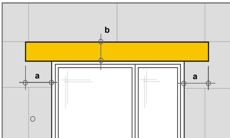
**Regelausführung Sturz und Laibungen mit Dämmstoffdicke  $\leq 300$  mm (siehe Abschnitt 3.2.4.3.1 b)**
