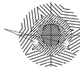
SAS Mikropfähle (Verpresspfähle mit kleinem Durchmesser) mit Traggliedern aus SAS-Stabstahl mit Gewinderippen S 555/700, Ø 57,5 mm und Ø 63,5 mm
