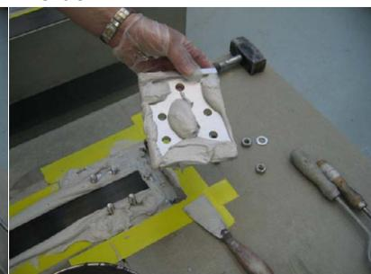
Auf die Deckplatte wird ebenfalls Klebstoff aufgetragen
