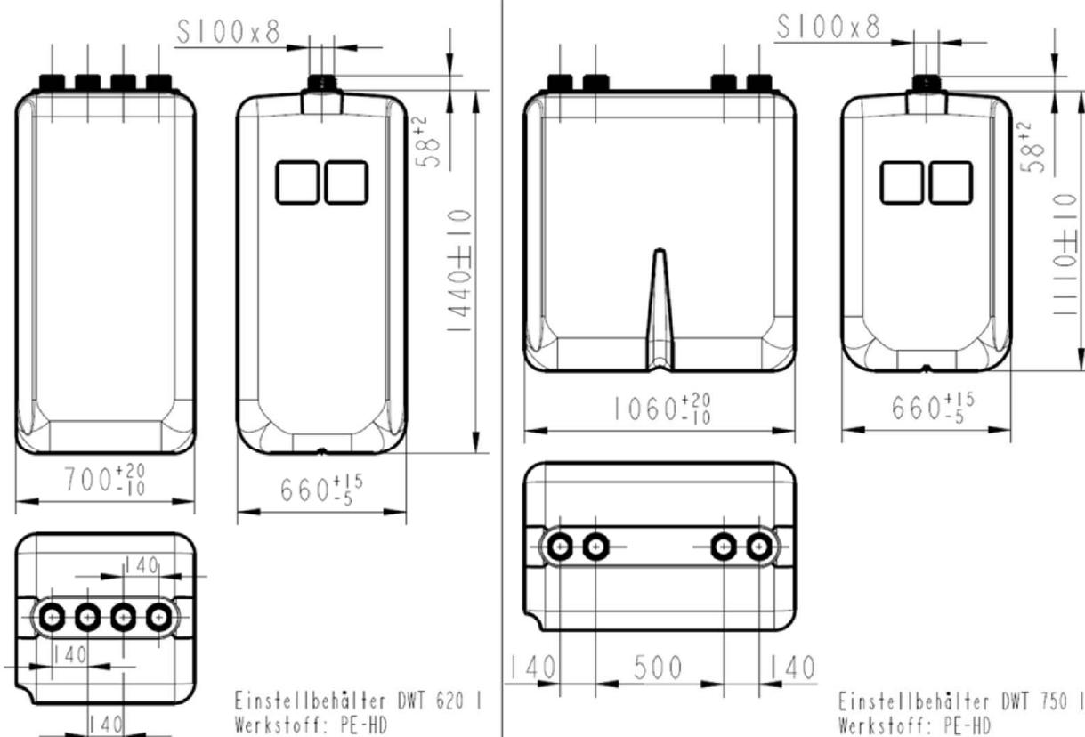
Blasgeformte Behälter aus Polyethylen (PE-HD)
