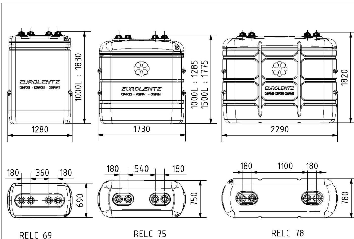
Blasgeformte Behälter mit integrierter Auffangvorrichtung aus Polyethylen (PE-HD)
