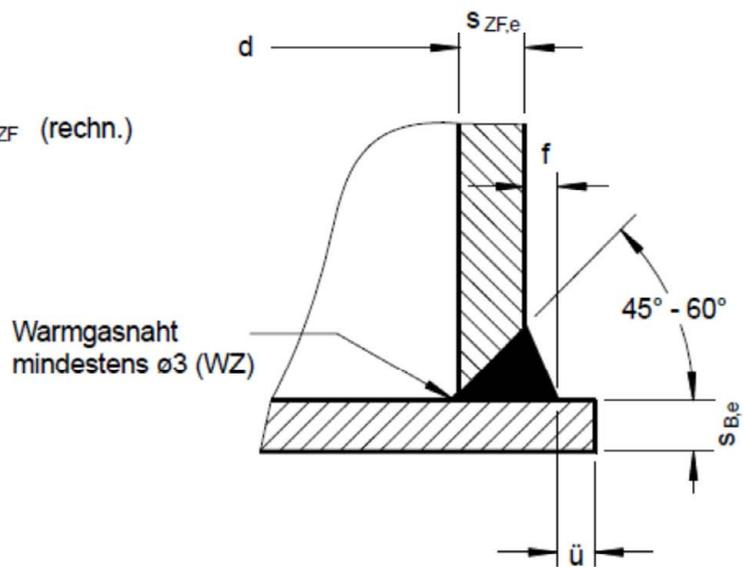
Flachbodenbehälter und Auffangvorrichtung aus Polyethylen (PE)
