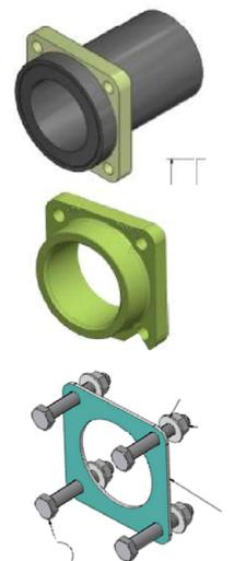
Einwandiges Rohrleitungssystem aus Kunststoff (Entlüftungsleitung) zur unterirdischen Verlegung in Tankstellen, UPP-System
