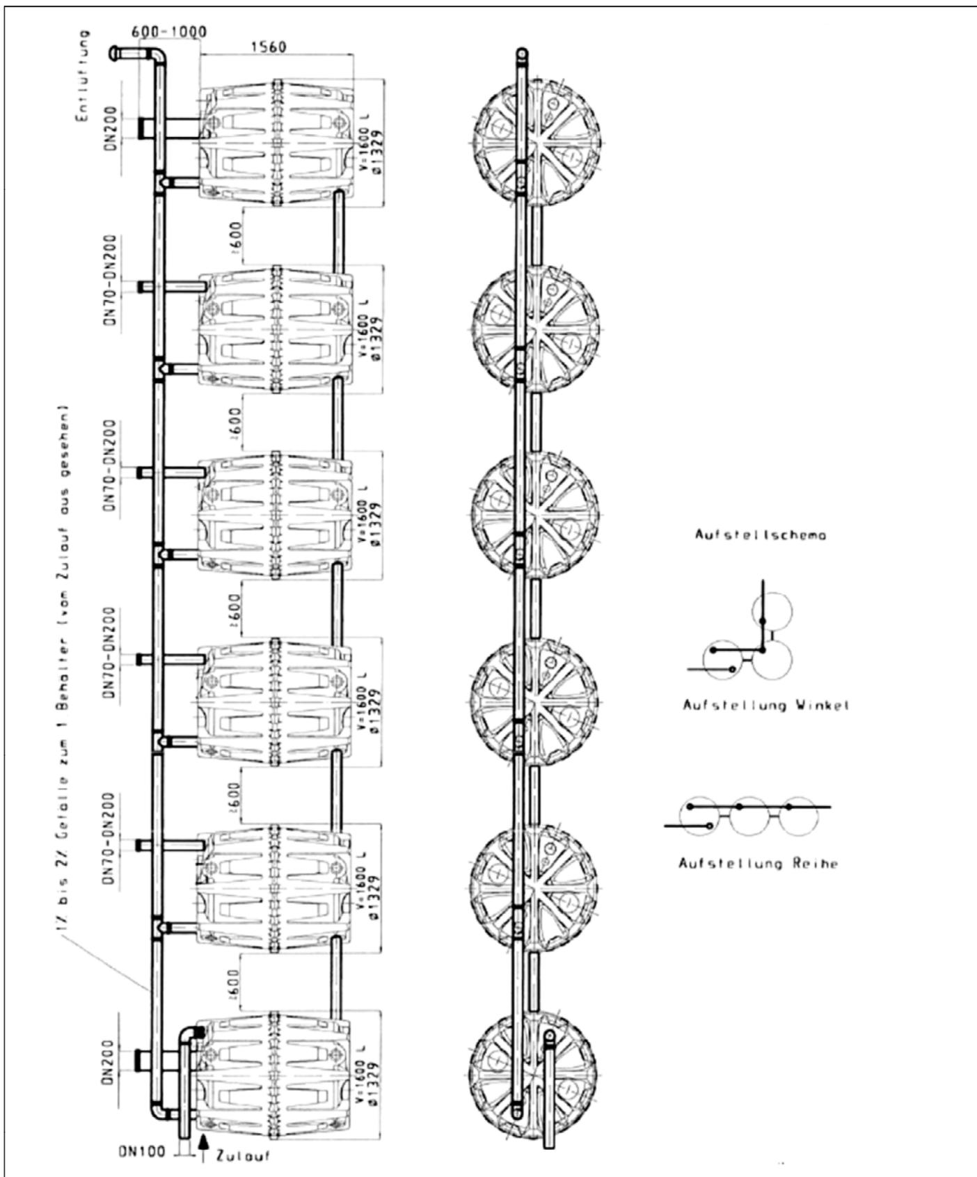
Abflusslose Sammelgrube aus glasfaserverstärktem Polypropylen,
