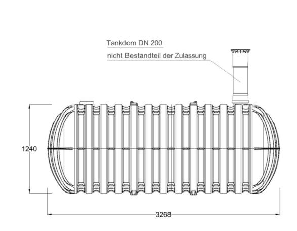
Abflusslose Sammelgrube aus Polyethylen (PE-LMD) für die Lagerung von häuslichem Abwasser Typ: "Stabilus" 3000 l
