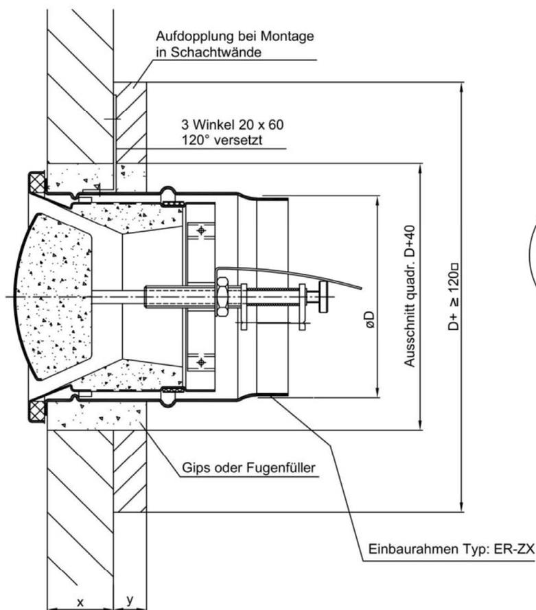
F30 x = Schachtwände mind. 24 mm | x + y mind. 60 mm
