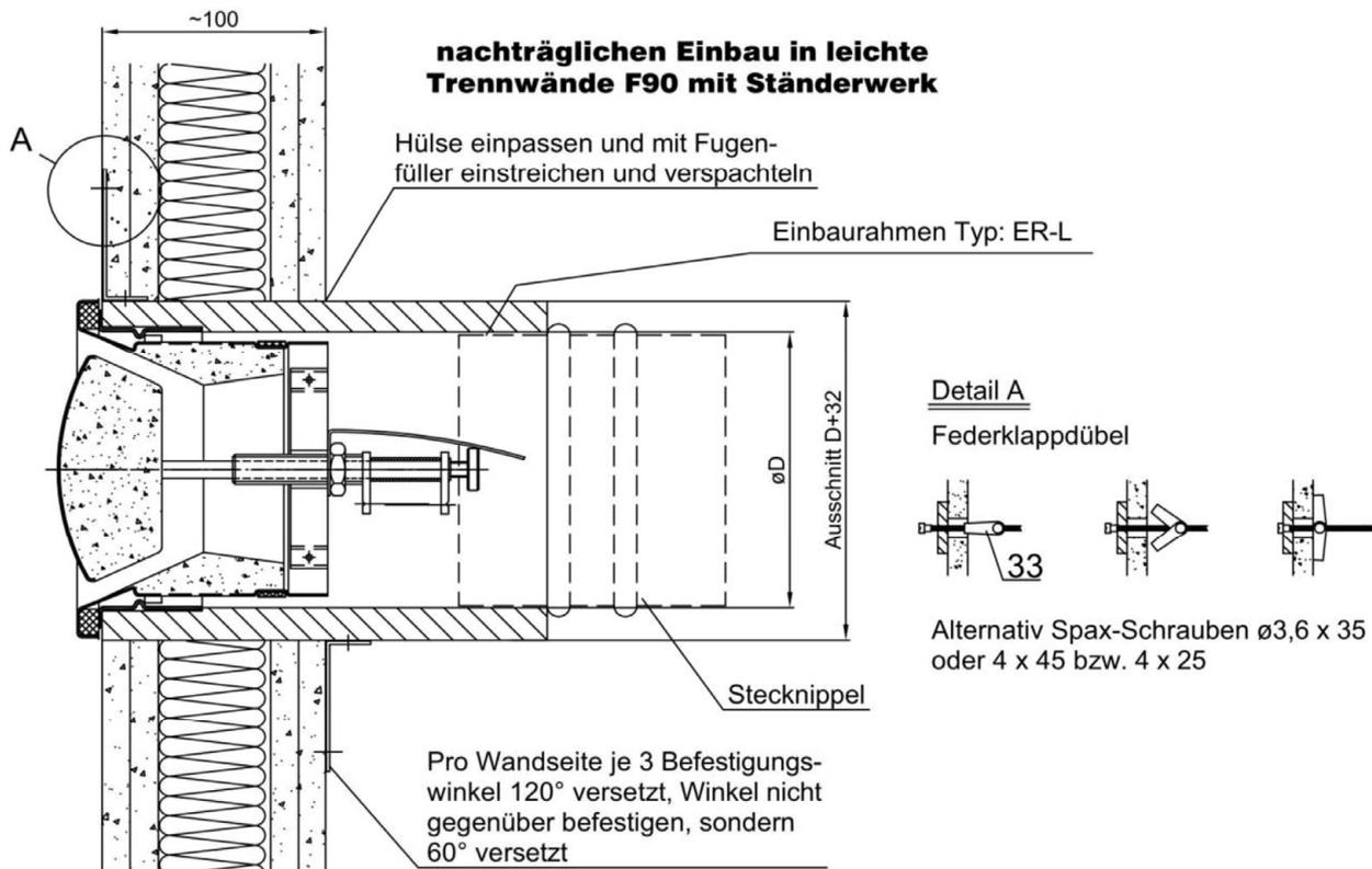
Absperrvorrichtungen gegen Feuer und Rauch in Lüftungsleitungen der Serie BCF
